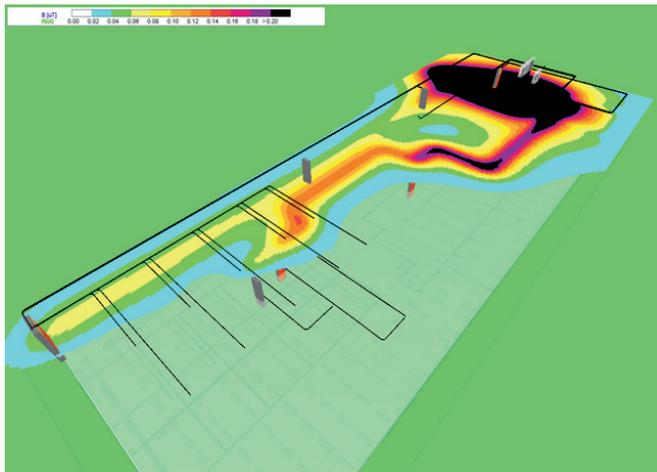
2-D-Darstellung der magnetischen Flussdichte in 1m Höhe über Fußboden, 1.OG
